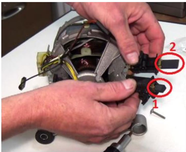
Εικόνα 9: Χαρακτηριστική εικόνα φθαρμένης ψήκτρας (1) ηλεκτρικού κινητήρα σε σύγκριση με μία καινούρια (2), σε μοτέρ τάξης μεγέθους παρόμοιας με το χρησιμοποιούμενο στην ηλεκτροϋδραυλική αντλία του συστήματος χειρισμού του πηδαλίου του Α/Κ «ΑΓΙΑ ΜΑΡΙΝΑ»
